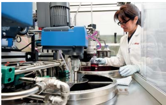
Ispitivanje učinkovitosti filtriranja i sposobnosti zadržavanja čestica (DIN ISO 19438)
