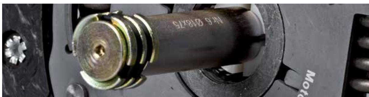
Ispravno sastavljanje zatika za centriranje ovisi o unutarnjem promjeru potpornog ležaja ili prvrta koljenastog vratila i o udaljenosti između potpornog ležaja ili prvrta koljenastog vratila i profila glavine lamele spojke.
