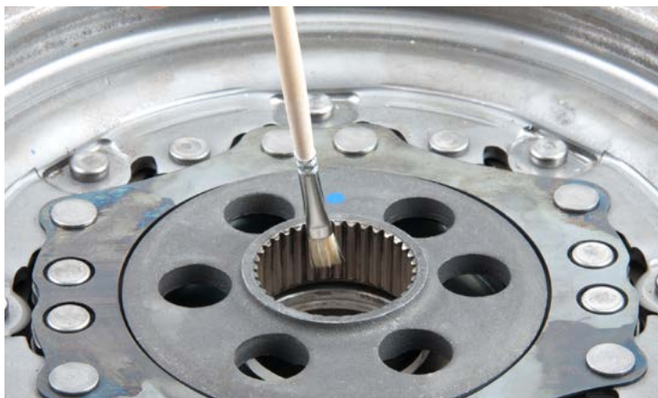
Slika 1: Ozubljenje prirubnice zamašnjaka podijeljene mase potrebno je podmazati prilikom svakog izvođenja servisnih radova
